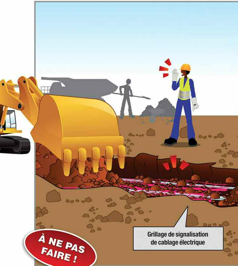
Grillage de signalisation de cablage électrique
